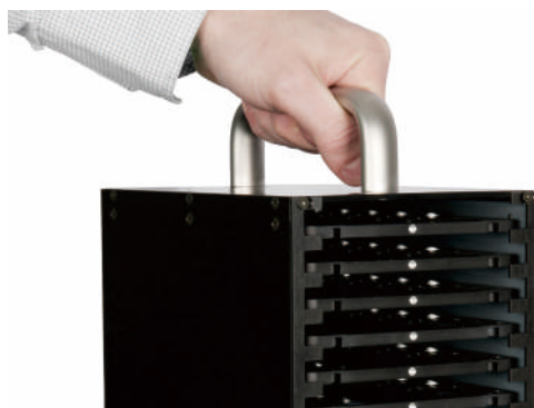
全新的 SlideFeeder x80 可升级至880片，样本可以轻松地从玻片架库中装载。
